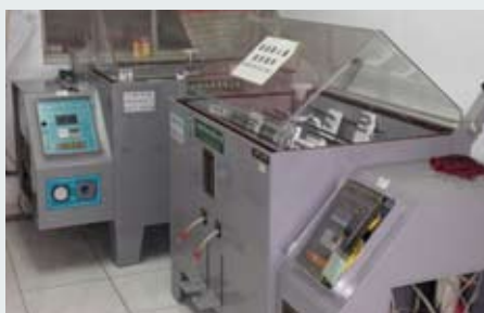
XRF a solná komora používaná pro kontrolu kvality povlaků Zn-Ni
