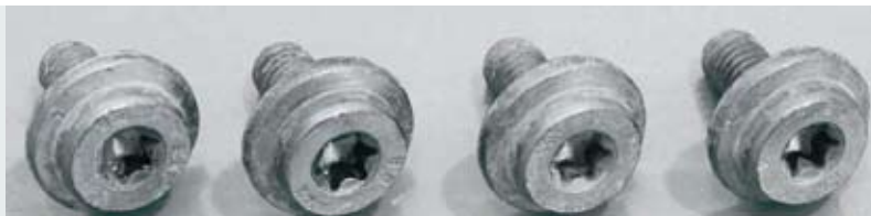
Spojovací materiál po 1000 h neutrální solné mlhy dle ISO 9027
