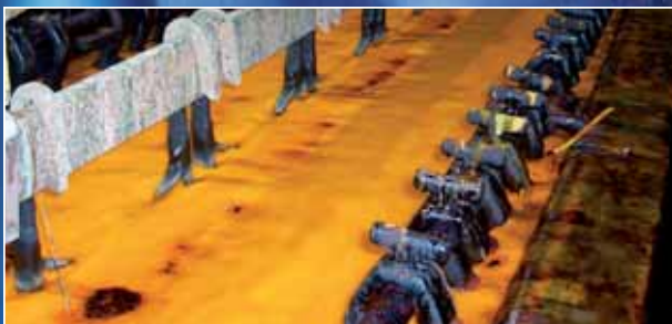
Tvrdochromovací lázeň s pěnou vytvořenou přípravkem Fumetrol 21
