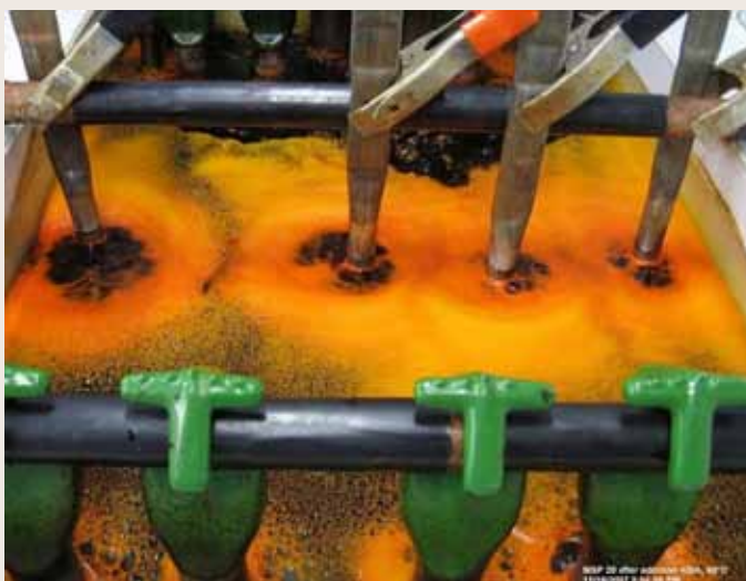
Fumetrol 21 LF vytvoří na hladině chromovací lázně souvislou nízkou vrstvu pěny, která zabraňuje úletu aerosolů z lázně
