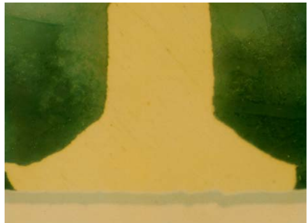
ABB 15 Querschliff eines Goldballbonds auf Ni/Pd/Au nach 2000 Stunden Auslagerung bei 150°C
