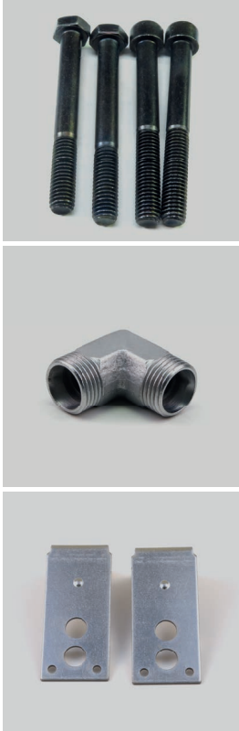
Abb. 1: Schrauben: Hiron® + Schwarzpassivierung + Nachtauchlösung + Sealer 350 WL8
